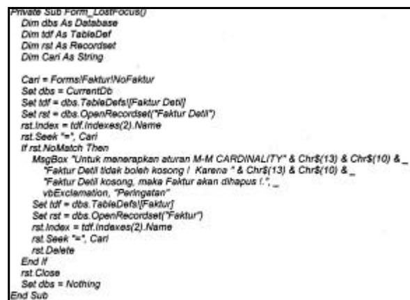
**Gambar 5b. Program Aplikasi untuk Mengimplementasikan Constraint M-M**
